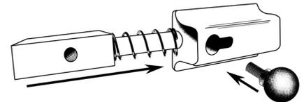
**15** Localice los faldones largos (I) e inserte las clavijas en los manguitos de metal afianzados a la parte inferior de la jaula.
