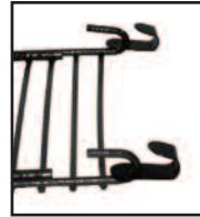
**20.** Sujetar las grapas de la rampa insertando dos ganchos en los agujeros de las grapas de la rampa. Los ganchos de la rampa y los "ganchos" de las grapas de la rampa deben estar enfrentados en la misma dirección.
