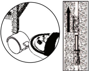
**Ruedecillas de sujeción** – las ruedecillas delanteras pueden bloquearse para impedir cualquier movimiento inesperado de la jaula.
